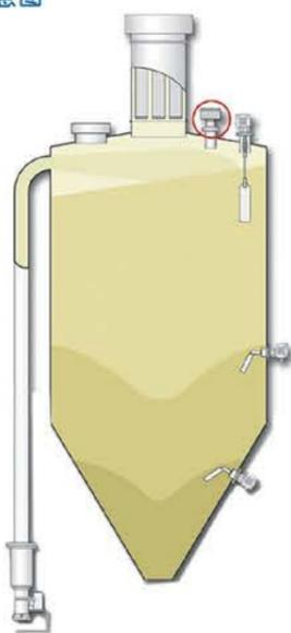
隔膜式料仓压力开关是在气动式填充过程中防止料仓压力过高而遭到破坏的保护设备。
